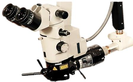
Figure 4 : Micromanipulateur relié au microscope opératoire
